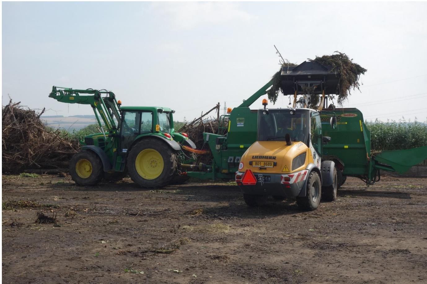
**PŘESÍVÁNÍ VYPRODUKOVANÉHO KOMPOSTU ROTAČNÍM SÍTEM NA KOMPOSTÁRNĚ**
